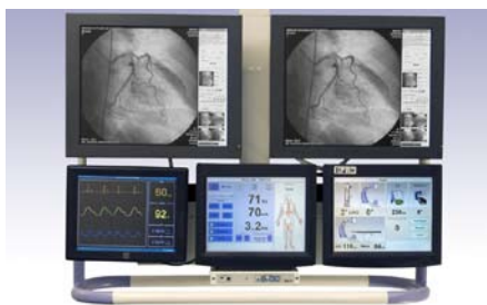
Os monitores possuem estação de trabalho com sofisticado software XImage, para aquisição, visualização e pós processamento das imagens e completa emissão de relatórios, com análises quantitativas gráficas para estenoses e ventriculografia.
